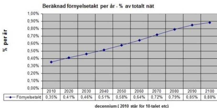
Figur 2. Karlstad kommuns beräknade förnyelsebehov av avloppsledningar de kommande 100 åren baserat på existerande ledningsnät.
